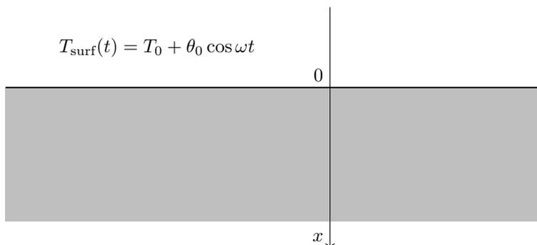
On se place à 1 D :  $T = T(x, t)$ . On résout l'équation de diffusion thermique :
