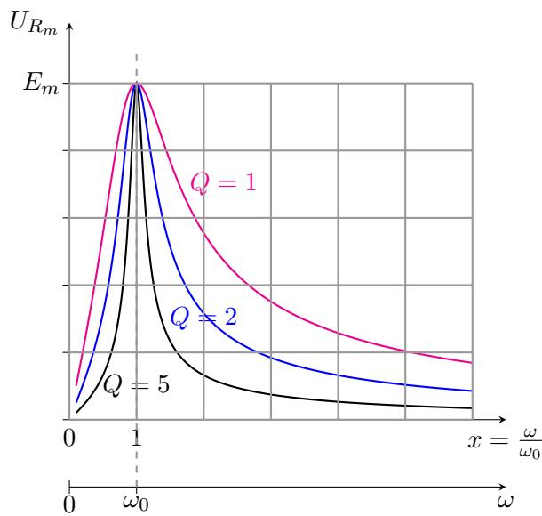
Quel que soit le facteur de qualité, la résonance en tension aux bornes de la résistance se produit pour  $x = 1$  donc pour  $\omega = \omega_0$ .
