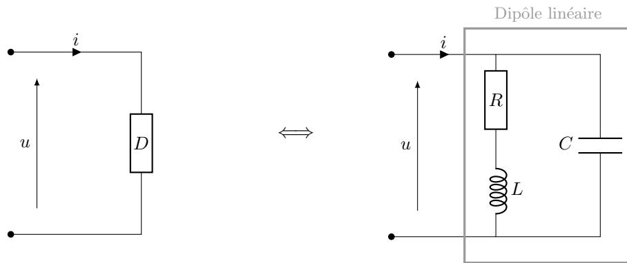
On peut montrer que la tension  $u$  et l'intensité  $i$  sont liés par une équation différentielle linéaire à coefficient constants, par exemple ici :
