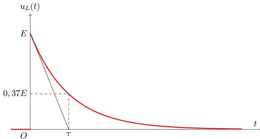
La tension aux bornes de la bobine est discontinue à  $t = 0$ .
