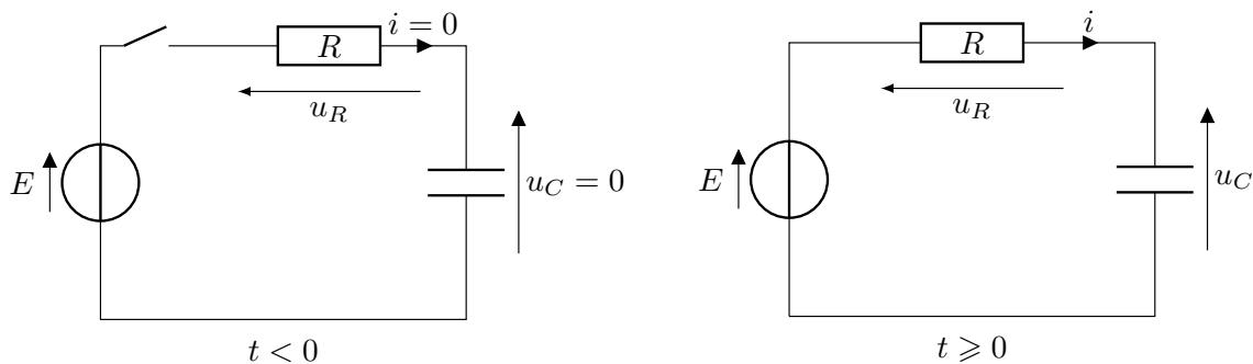
Analyser l'évolution de la tension  $u_c$  aux bornes du condensateur.
