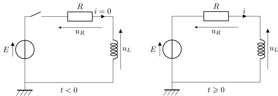
Analyser l'évolution de l'intensité  $i$  du courant après la fermeture de l'interrupteur.
