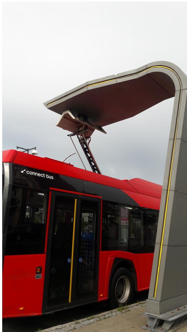
Grâce aux "supercondensateurs" la recharge d'un bus ne prend que quelques minutes.
