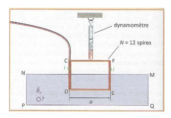
On suppose également que, dans le plan du cadre, la zone de champ magnétique uniforme est approximativement délimitée par un rectangle MNQP et que l'intensité du champ est négligeable à l'extérieur de cette zone. On observe alors qu'un courant de 0,83 A circulant dans le sens CDEF conduit à une situation d'équilibre du cadre où l'indication donnée par le dynamomètre augmente de 0,76 N.
