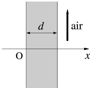
Une couche d'isolant d'épaisseur  $d = 10$  cm et de conductivité thermique  $\lambda = 0,04 \text{ W}\cdot\text{m}^{-1}\cdot\text{K}^{-1}$ , a une face maintenue à la température  $\theta_1 = 100^\circ\text{C}$ .
