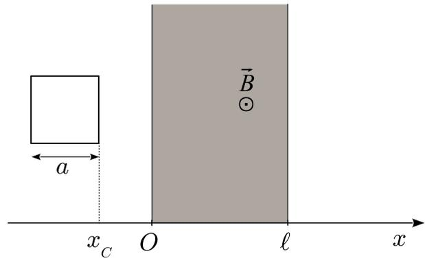
On lance le cadre avec une vitesse  $v_0\vec{e}_x$  depuis la partie de champ magnétique nul correspondant à  $x_C < 0$ . Le cadre pénètre dans la zone de champ magnétique non nul à  $t = 0$  et on étudie ensuite la dynamique du cadre. Le circuit défini par le cadre a une masse  $m$  et présente une résistance  $R$ . Son inductance propre est supposée négligeable.
