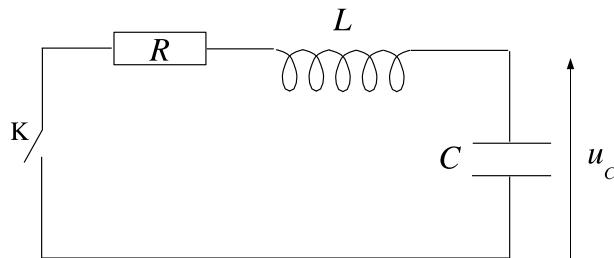
À  $t = 0$ ,  $u_C = u_0 = 10$  V et on ferme l'interrupteur  $K$ . On donne  $L = 10$  mH et  $C = 10$  nF.
