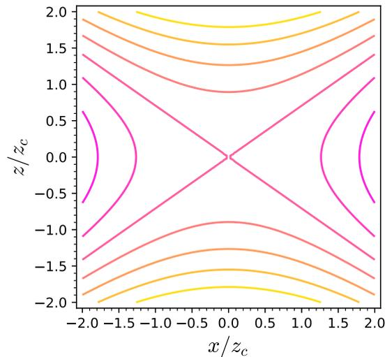
Visualisation des isopotentiels dans le plan  $y = 0$  (valable dans tout plan contenant l'axe  $Oz$  car les électrodes sont invariantes par rotation quelconque autour de  $Oz$ ) : les électrodes coïncident avec des surfaces isopotentiellles ( $V = U/2$  et  $V = -U/2$ )
