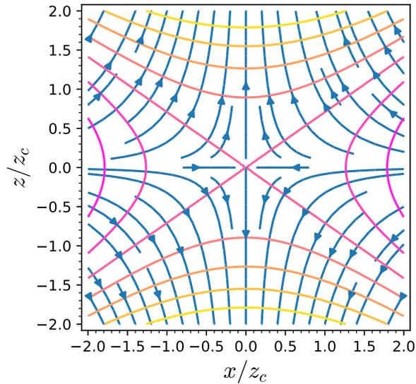
Superposition des isopotentiels et des lignes de champ électrostatique orientées dans le sens des potentiels décroissants.
