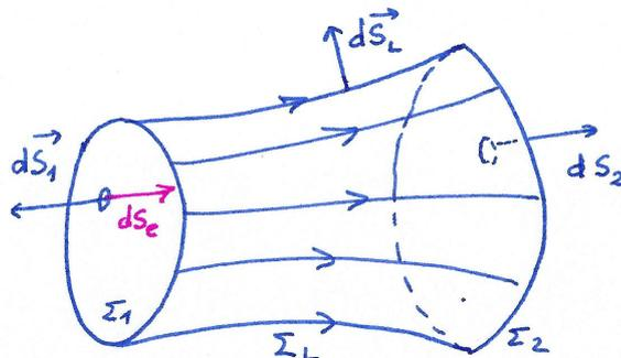
Ainsi, si on définit le flux entrant  $\phi_e = \iint_{\Sigma_1} \vec{A} \cdot d\vec{S}_e$  et le flux sortant par  $\phi_s = \iint_{\Sigma_2} \vec{A} \cdot d\vec{S}_2$ , on a
