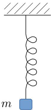
Exemple : On souhaite déterminer la période  $T_0$  des oscillations verticales d'une masse accrochée à un ressort.
