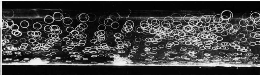
Visualisation des trajectoires des particules fluides lors du passage d'une onde de surface progressive sinusoïdale dans un canal. Des particules en suspension dans le fluide sont photographiées avec un temps de pose correspondant à une période (*An album of fluid motion*, Van Dyke.)
