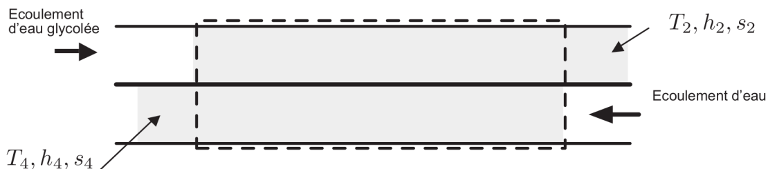
FIGURE 2 - Échangeur à l'instant final
