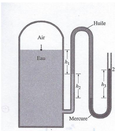
L'eau dans un réservoir est pressurisée par une couche d'air. La pression est mesurée à l'aide d'un manomètre multi-fluide (voir figure ci-contre).
