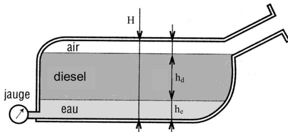
Le principal danger pour les moteurs diesel est une forte présence d'eau dans le carburant. L'indication de remplissage d'un réservoir de carburant est proportionnelle à la pression mesurée par une jauge placée au fond du réservoir. L'eau, de densité plus élevée que le diesel, vient se loger au fond du réservoir, faussant ainsi la mesure prise par la jauge. Le réservoir possède une hauteur totale  $H$ .
