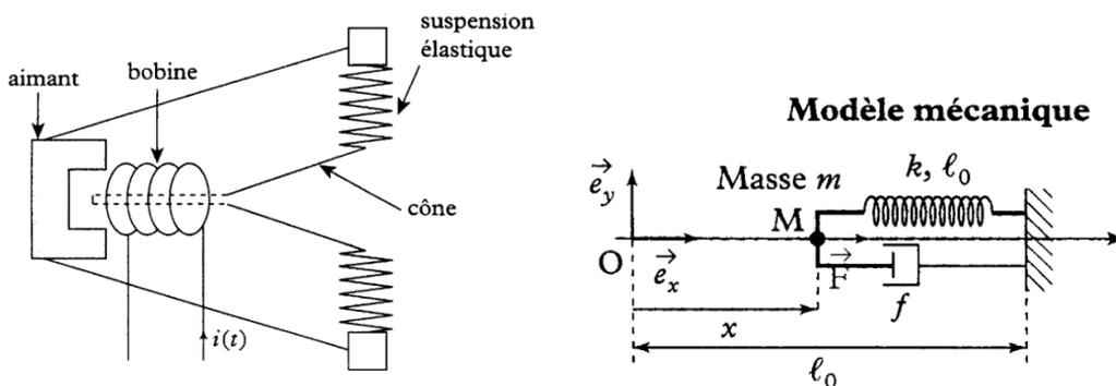
Elle est soumise à une force  $\vec{F}(t)$ , imposée par le courant  $i(t)$  entrant dans le haut-parleur. Cette force est proportionnelle au courant  $i(t)$  circulant dans la bobine et s'exprime sous la forme  $\vec{F}(t) = K_0 i(t) \vec{e}_x$ , avec  $K_0$  une constante. On suppose que le courant est sinusoïdal :  $i(t) = I_m \cos(\omega t)$ , avec  $\omega = 2\pi \times 1,0 \cdot 10^3$  rad.s<sup>-1</sup>.
