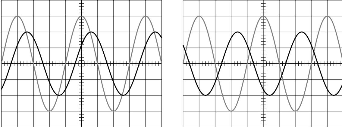
On visualise deux signaux sur un écran d'oscilloscope : le premier (en gris) s'exprime sous la forme :  $e(t) = e_m \cos \omega t$  et le second (en noir) s'exprime sous la forme  $s(t) = s_m \cos(\omega t + \varphi)$  avec  $\varphi \in ]-\pi, \pi]$ . Exprimer  $\varphi$  dans chacun des cas.
