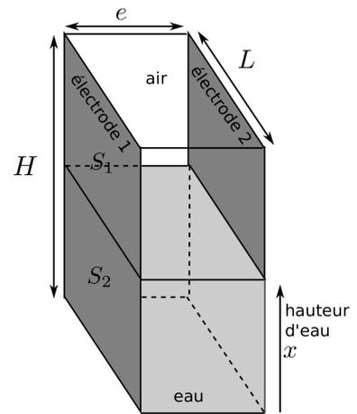
1. Établir l'expression de la capacité totale  $C = C_1 + C_2$ , et l'écrire sous la forme  $C = ax + b$ , avec  $a$  et  $b$  des constantes à exprimer en fonction des dimensions  $H$ ,  $L$  et  $e$  du condensateur, de  $\epsilon_0$  et de la permittivité diélectrique relative  $\epsilon_r$  de l'eau.
